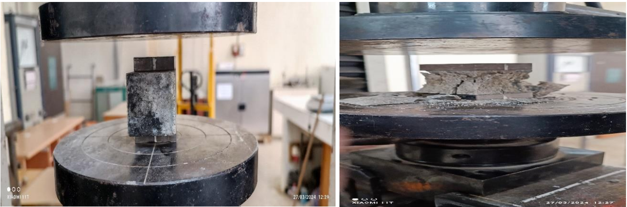
Figure II.15 : Test de résistance à la compression.
