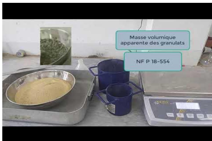
Figure II.8 : Essai de détermination de la masse volumique apparente.
