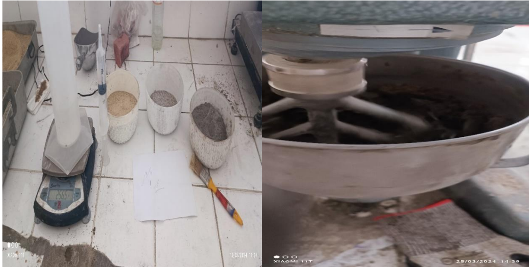
Figure II.10 : Principe de la confection des mortiers.
