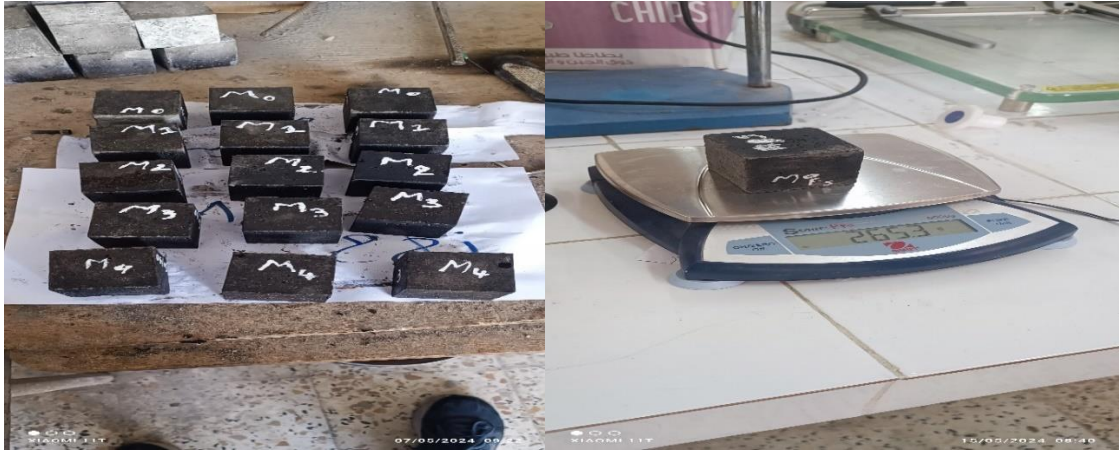
Figure II.12 : Éprouvettes cubiques utilisées pour l'absorption.
