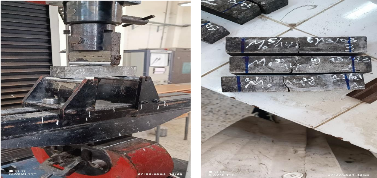
Figure II.13 : Test de résistance à la flexion.
