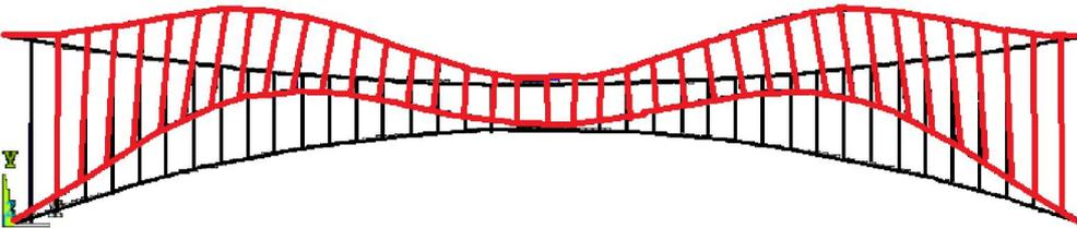
Figure 5-31: Forme du mode 3 (symétrique)
