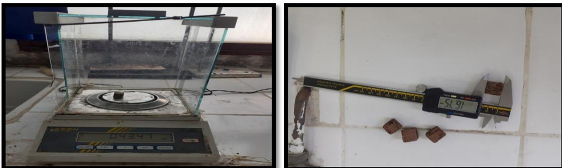
Figure 16 : Les éprouvettes utilisées pour la mesure de la densité (à droite) et la balance de mesure de la masse des éprouvettes (à gauche).
