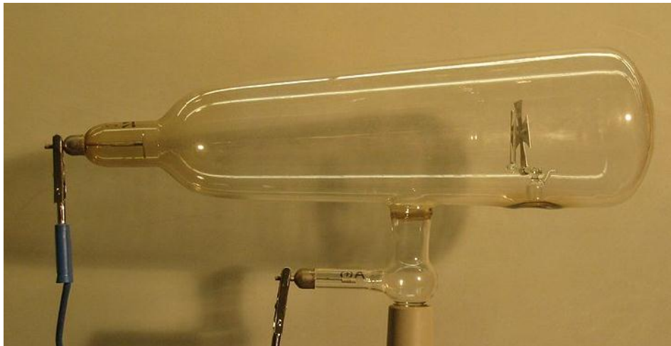
Fig. 1.3 Mise en évidence des rayons cathodiques.
