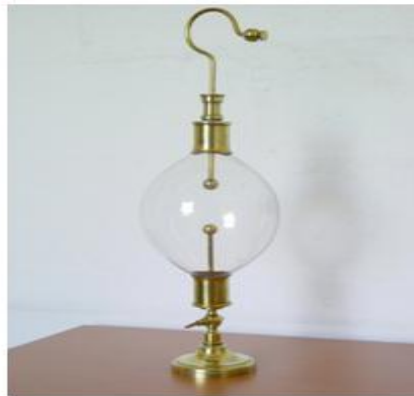
Fig.1.1 Appareil de Faraday pour étudier les décharges électriques dans les gaz.
