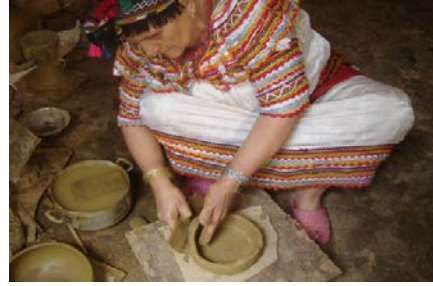
Figure 5 : façonnage des bords du fond à l'aide de Imceđ
