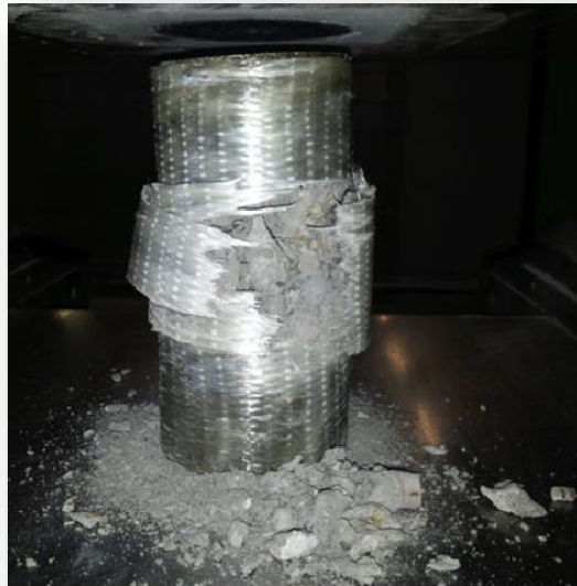
Figure II.15. Photo de la décohésion du béton confiné en fin d'essai, (Université Gent, Belgique).
