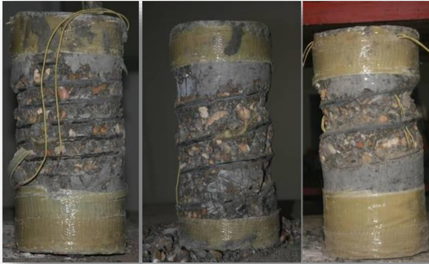
Figure II.11: Échec typique des spécimens. [9].
