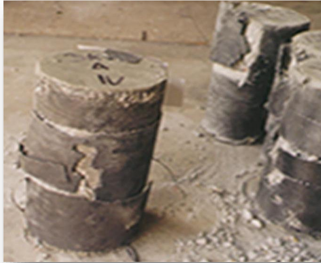
Figure II.9: Mode de rupture d'un cylindre enveloppé par des fibres de carbone.
