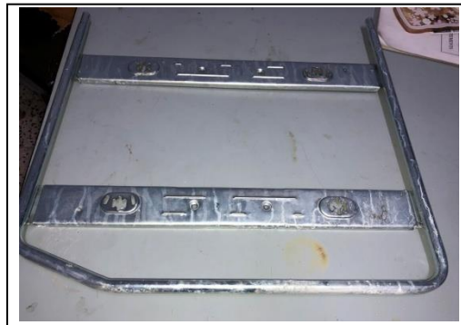
Figure III.16 : Résultat de l'essai du brouillard salin sur le revêtement de Zingage
