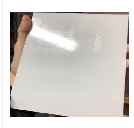
Figure III.7 Résultat essai quadrillage pour la peinture (ENAP)
