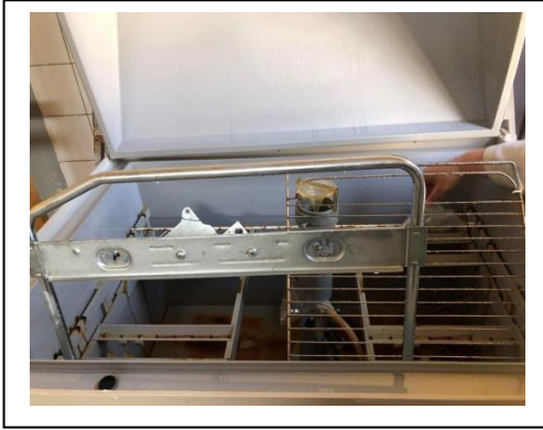
Figure II.15.a : La rampe et la grille dans le brouillard salin
