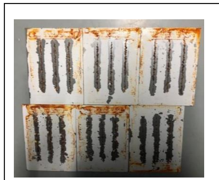
Figure III.14 : Résultat de l'essai du brouillard salin sur la peinture ENAP.
