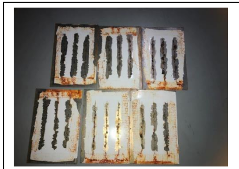
Figure III.13 : Résultat obtenus de test du brouillard salin sur la peinture JOTUN
