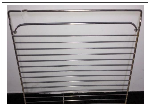
Figure III.11 La grille après Nickelage
