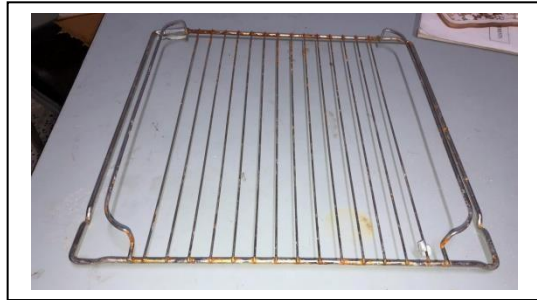
Figure III.15 : Résultat de l'essai du brouillard salin sur le revêtement de Nickelage.
