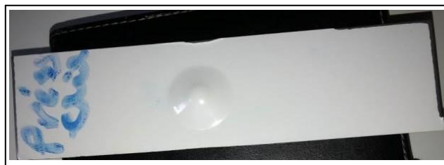
Figure III.9 : Résultat essai emboutissage (ENAP)
