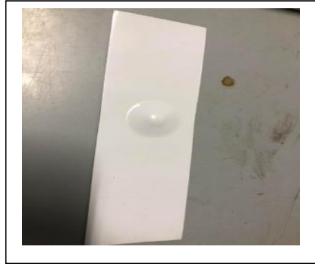
Figure III.5 Résultat de l'essai d'emboutissage (JOTUN)
