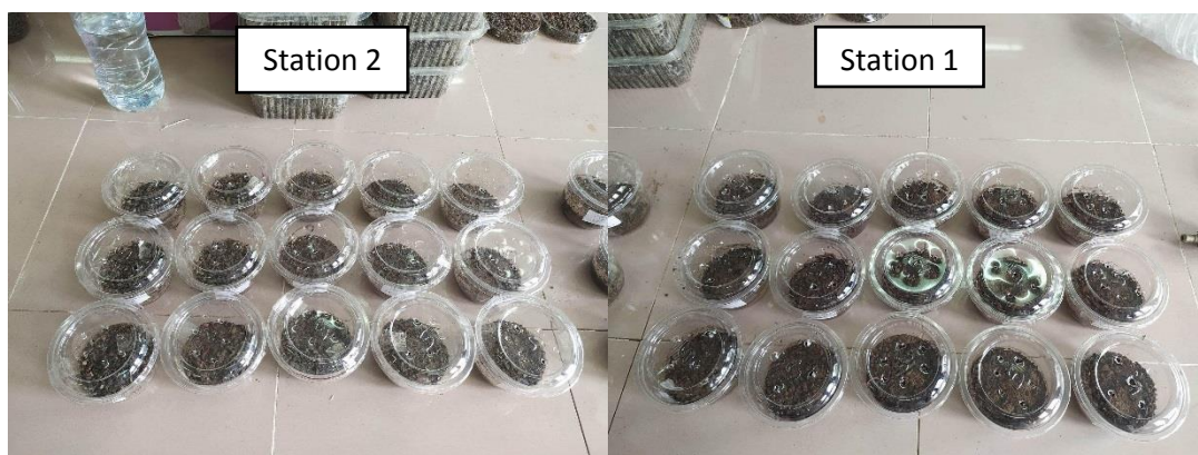
Figure 8 : Dispositif de l'essai de toxicité sur les vers de terre.
