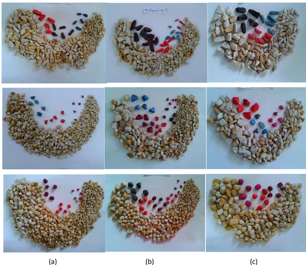
**Figure III.4 :** Différentes classes granulométriques étudiées 3.15/5 mm en (a), 3.15/8 mm en (b), 5/8 mm en (c) sous forme sous arrondie, anguleuse et allongée respectivement du matériau grès utilisé.
