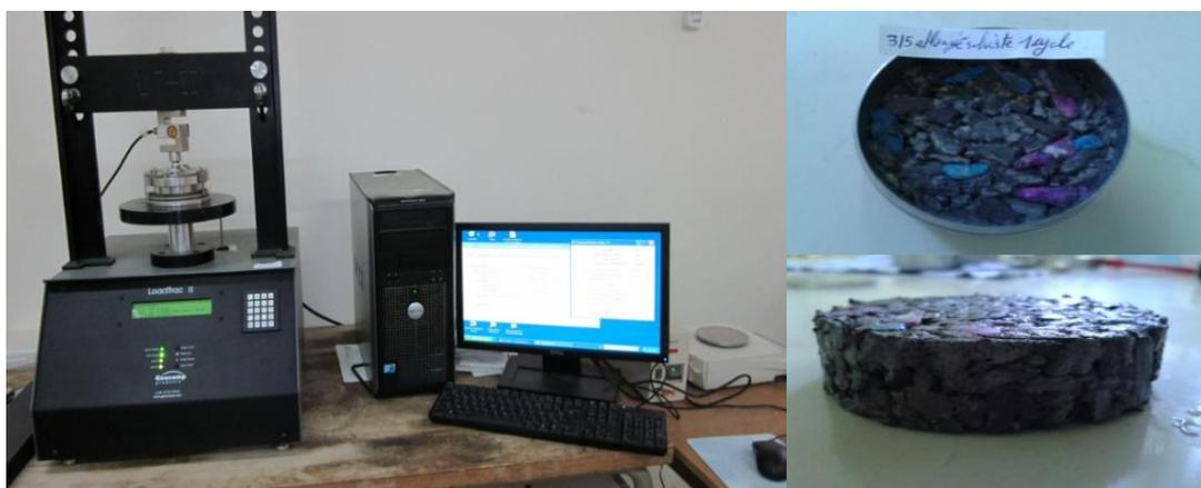
**Figure III.9 :** Dispositif œdométrique asservi de type *Geocomp Corporation*.
