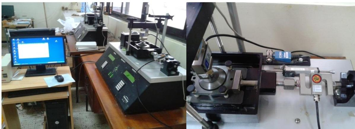
**Figure III.7 :** Dispositif de l'essai de cisaillement direct asservi de type *Geocomp Corporation*.
