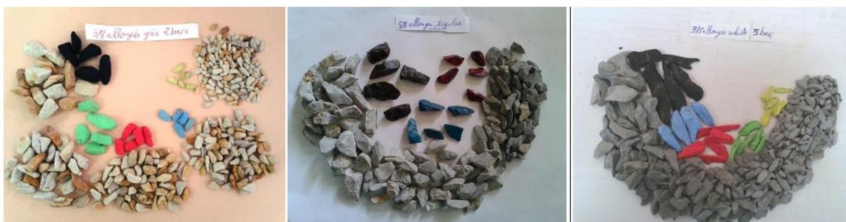
**Figure III.1** : Matériaux étudiés respectivement grès, calcaire et schiste.
