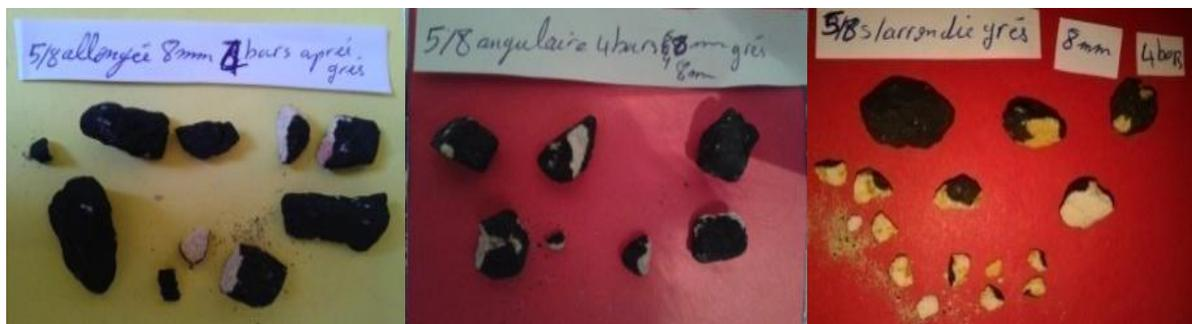
**Figure IV.13 :** Grains du grès de  $\varnothing = 8$  mm de formes sous arrondie, angulaire et allongée, après écrasement sous 400 kPa.
