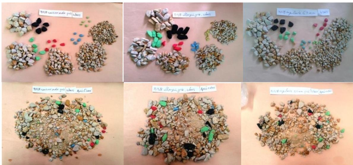
Figure IV.10 : Écrasement des grains du grès de classe 3.15/8 mm de forme sous arrondie, allongé et angulaire, sous la contrainte normale de 400 kPa à l’essai de cisaillement direct.
