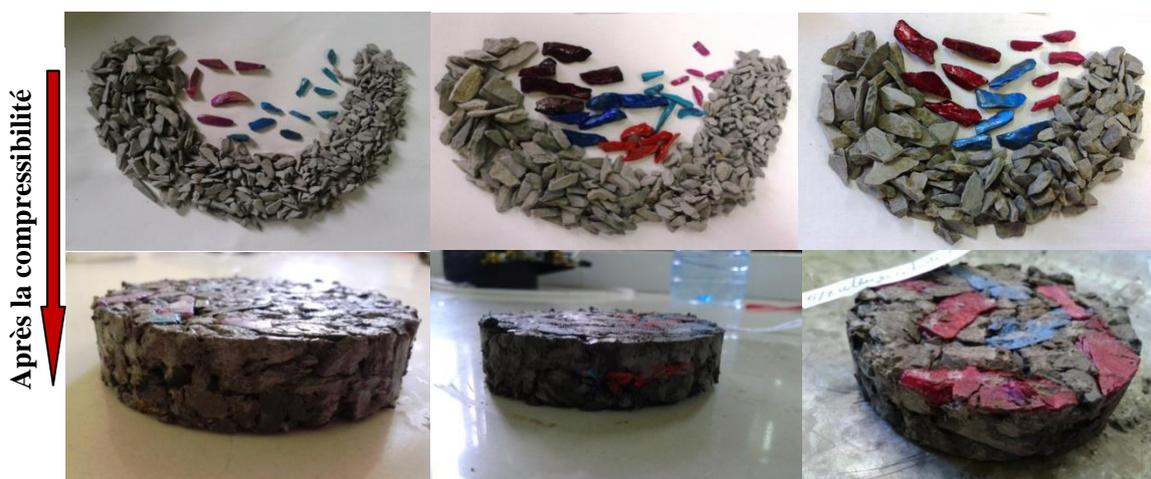
Figure IV.11 : Écrasement des trois classes étudiées du schiste allongé après cinq (05) cycles de chargement-déchargement à l’essai oedométrique.
