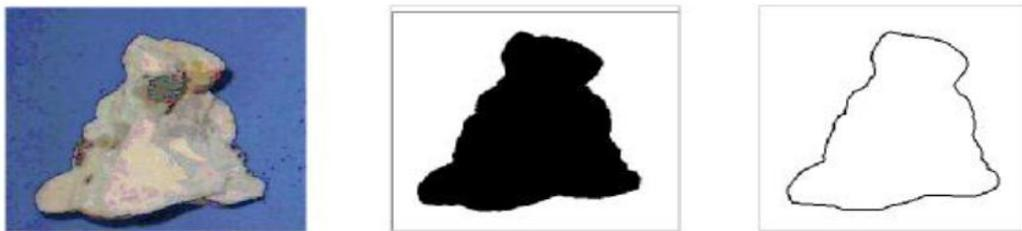
**Figure II.1 :** Exemple d'une image binaire obtenue après l'analyse d'image d'un grain de sable (ACHIR. M, 2011).
