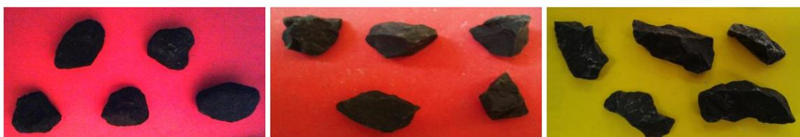
**Figure III.2 :** Formes utilisées, respectivement sous-arrondie, angulaire et allongée.
