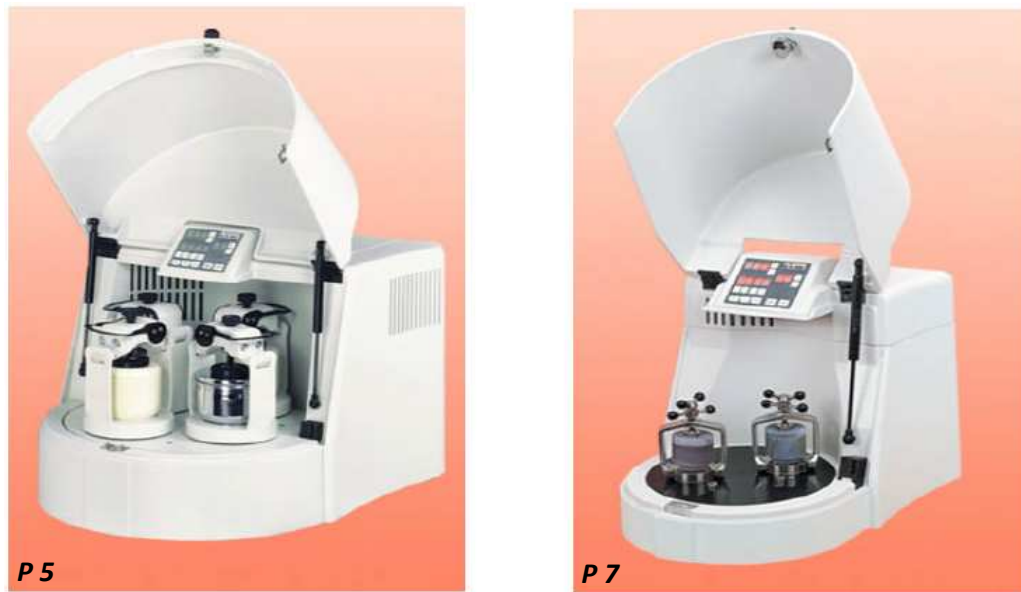
Fig. II.5. Broyeur planétaire à bille P5 et P7
