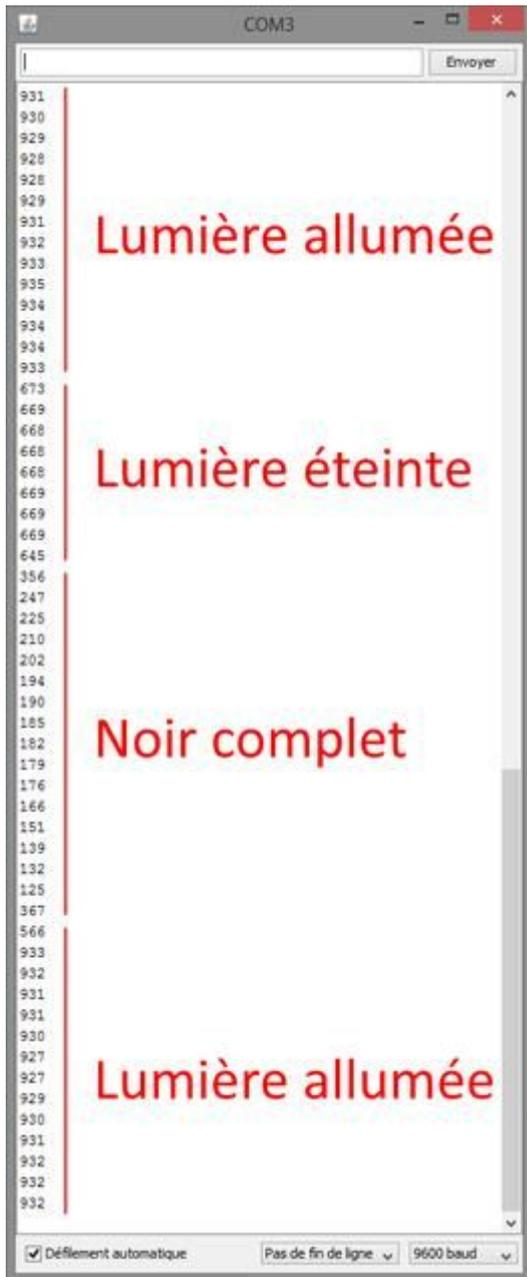
Figure 30: Exemple de valeurs relevées par la photorésistance
