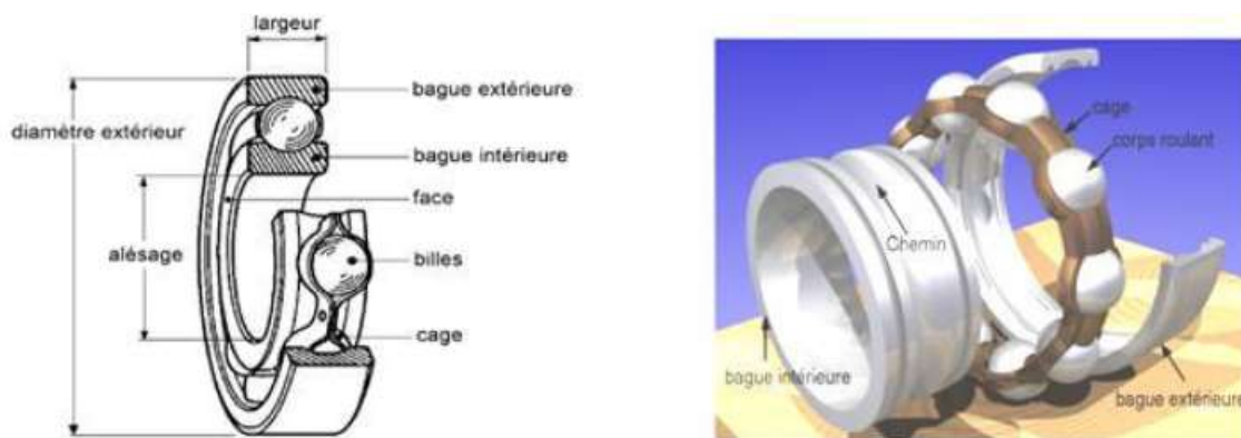
Figure III.13 : Eléments composant un roulement à bille.
