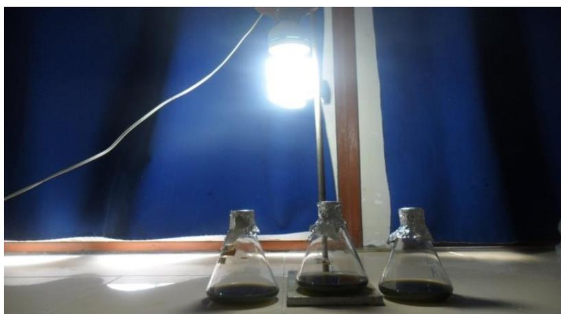
**Figure 12 :** Montage utilisé pour l'optimisation de la lumière de culture de spiruline.
