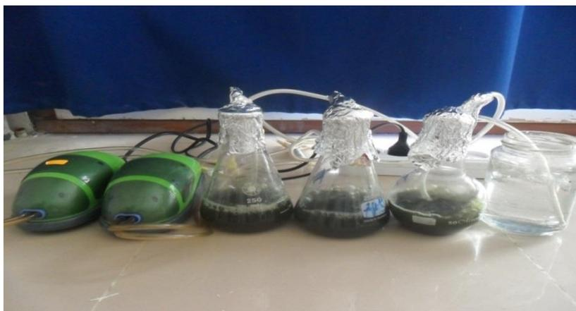
**Figure 11** : Montage utilisé pour l'optimisation de l'aération et de l'agitation de la culture de spiruline.
