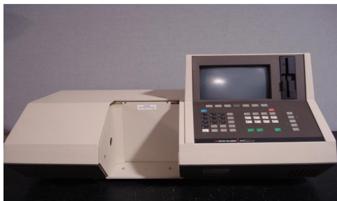
Figure 7. Spectrophotomètre infrarouge à transformée de Fourier Perkin Elmer 1600.
