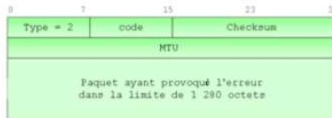
Figure III.3.7.1.2 : Format d'un message ICMP Paquet trop grand
