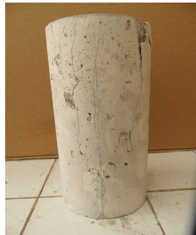
FIGURE 4.14 – Propagation des fissures suivant le sens de compression BR25.
