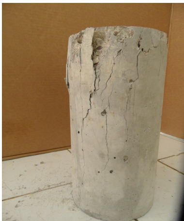
FIGURE 4.15 – Propagation des fissures suivant le sens de compression BR50.
