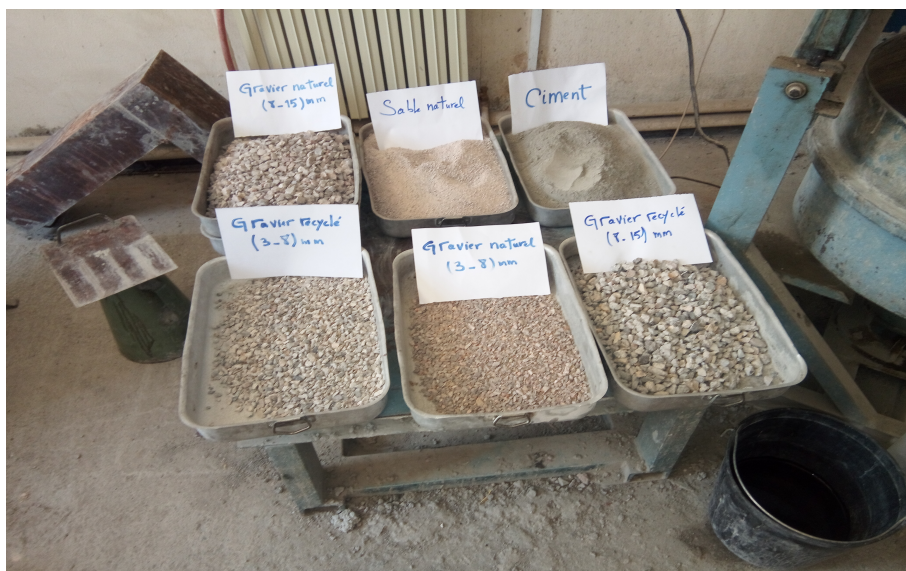
FIGURE 4.4 – Matériaux du béton.
