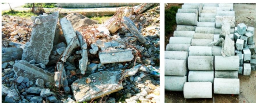
FIGURE 1.3 – Déchets de la démolition et de laboratoire.
