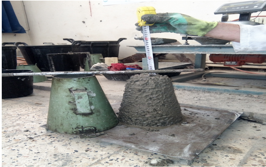
FIGURE 4.6 – Description d'essai d'affaissement.
