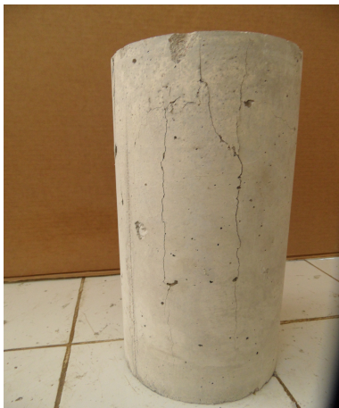
FIGURE 4.13 – Propagation des fissures suivant le sens de compression BN.
