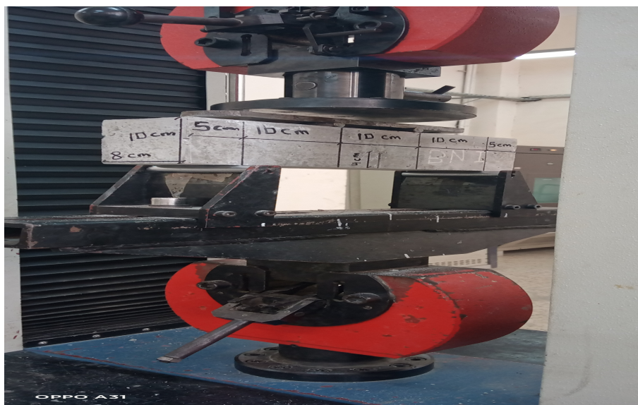
FIGURE 4.8 – Dispositif d'essai de flexion quatre points
