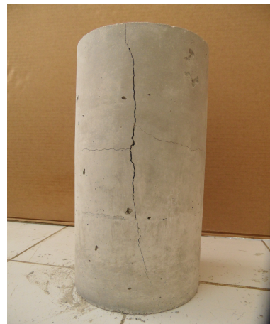
FIGURE 4.16 – Propagation des fissures suivant le sens de compression BR75.
