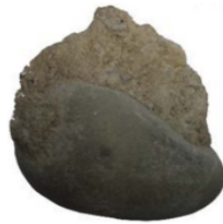
FIGURE 1.4 – Image correspondante à un granulat recyclé, granulat naturel entouré de mortier adhérent [43]
