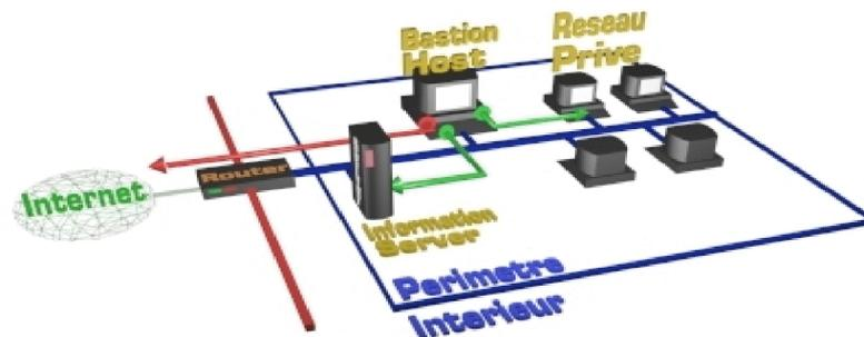
**Figure III.12 :** Exemple de Routeur filtre de paquets associé à une machine « bastion hosts »
