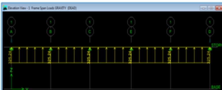
Figure VII.14: diagramme du chargement pour l'effort tranchant à l'ELU (sens longitudinal).
