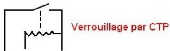
Fig.1.12. Représentation schématique du verrou de porte.
