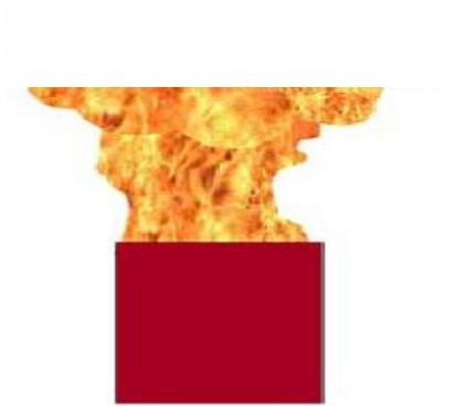
Une partie du liquide déborde du bac et une autre est mise en suspension en se fragmentant en gouttes et en se vaporisant en traversant les flammes pour former une zone de combustion vive. [12]
