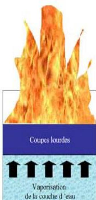
Le contact entre l'onde de chaleur et l'eau provoque la vaporisation de cette dernière. Cette vaporisation brutale conduit à une augmentation importante de volume et joue le rôle de piston en mettant en suspension le liquide inflammable restant dans le bac. [11]
