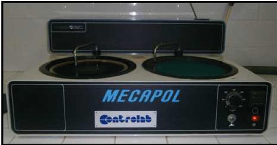
**Figure IV-7:** polisseuse a deux disques
