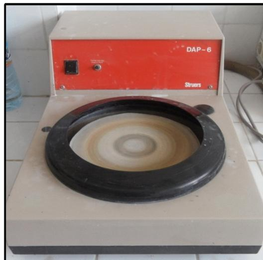
**Figure IV-8:** Polisseuse de finition
