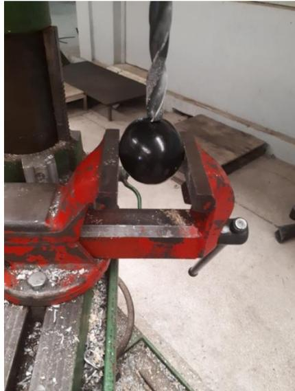
**Figure III.4 :** Le perçage des boules.
