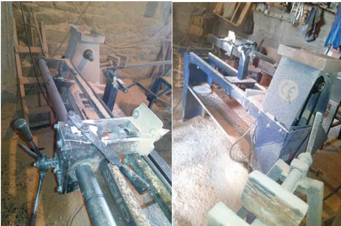
**Figure III.1:** Le tour d'usinage du bois.
