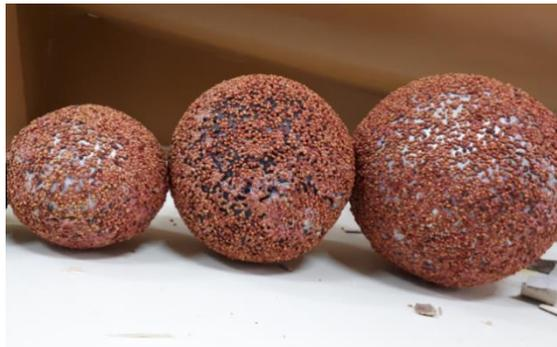
**Figure III.8 :** Les boules après le collage des grains de rugosité.
