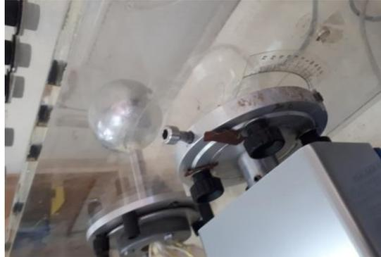
**Figure III.7:** Mesure des coefficients de pressions pour une sphère lisse.
