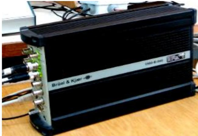
**Figure III.14 :** Convertisseur du signal.
