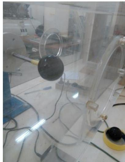
**Figure III.5 :** A gauche : la tige de fixation A droite : la boule placée dans la soufflerie.
