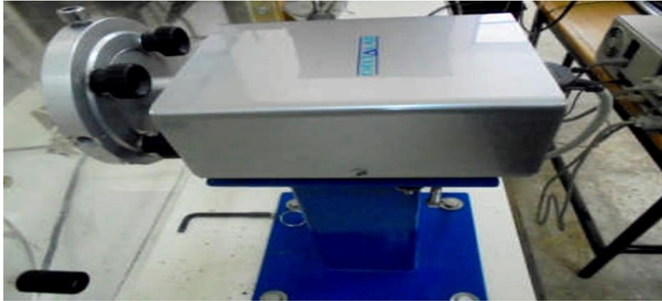
Figure III.12 : Balance aérodynamique.
