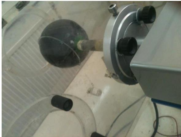
**Figure III.10.a** : La mise d'un anneau sur les sphères
