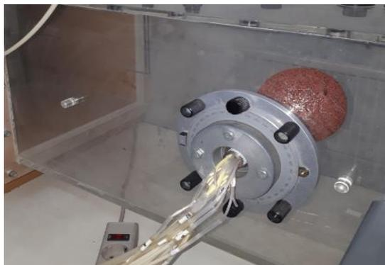
**Figure III.9 :** La boule avec la rugosité dans la soufflerie.
