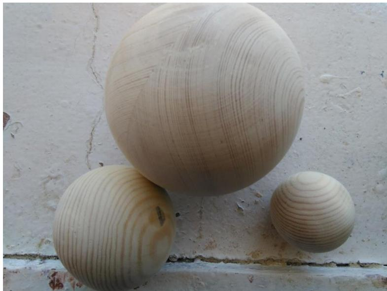
**Figure III.3 :** Les boules après l'ajustage de leurs surfaces.
