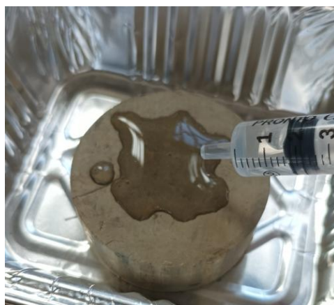
Figure V.2 : Saturation d'un échantillon à l'aide d'une seringue.
