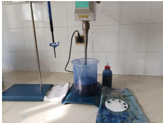
Figure IV.11 : Déroulement de l'essai au bleu de méthylène.
