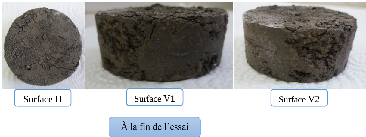
Figure V.5 : Images de l'échantillon de la marne d'Azazga au cours de l'essai aux canicules.
