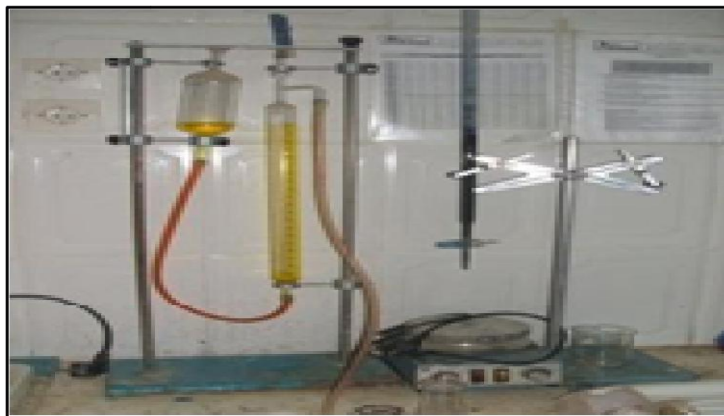
Figure IV.14 : Appareil de détermination de \text{CaCO}_3 .
