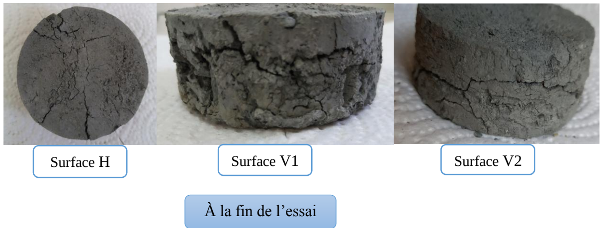
Figure V.6 : Images de l'échantillon de la marne de Boghni au cours de l'essai aux canicules.
