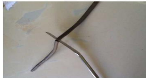
Figure IV.10 : La fissuration et brisure du rouleau [30].
