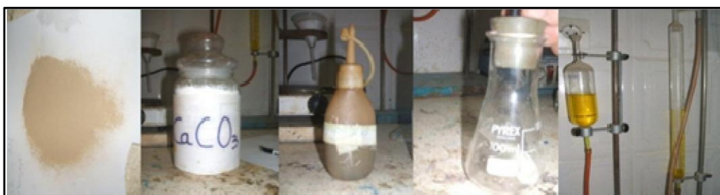
Figure IV.15 : Principales étapes de la méthode de calcimètre.
