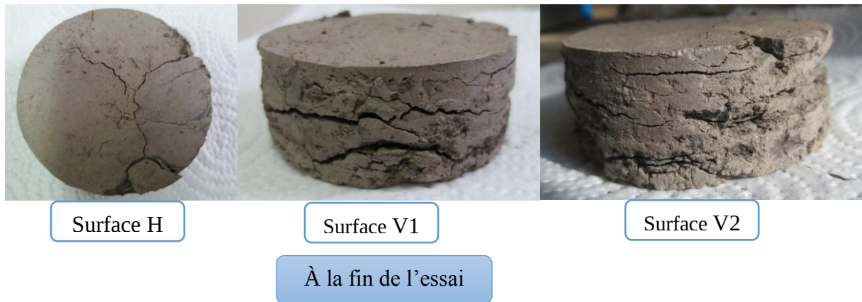
Figure V.4 : Images de l'échantillon de la marne d'Ait Toudart au cours de l'essai aux canicules.
