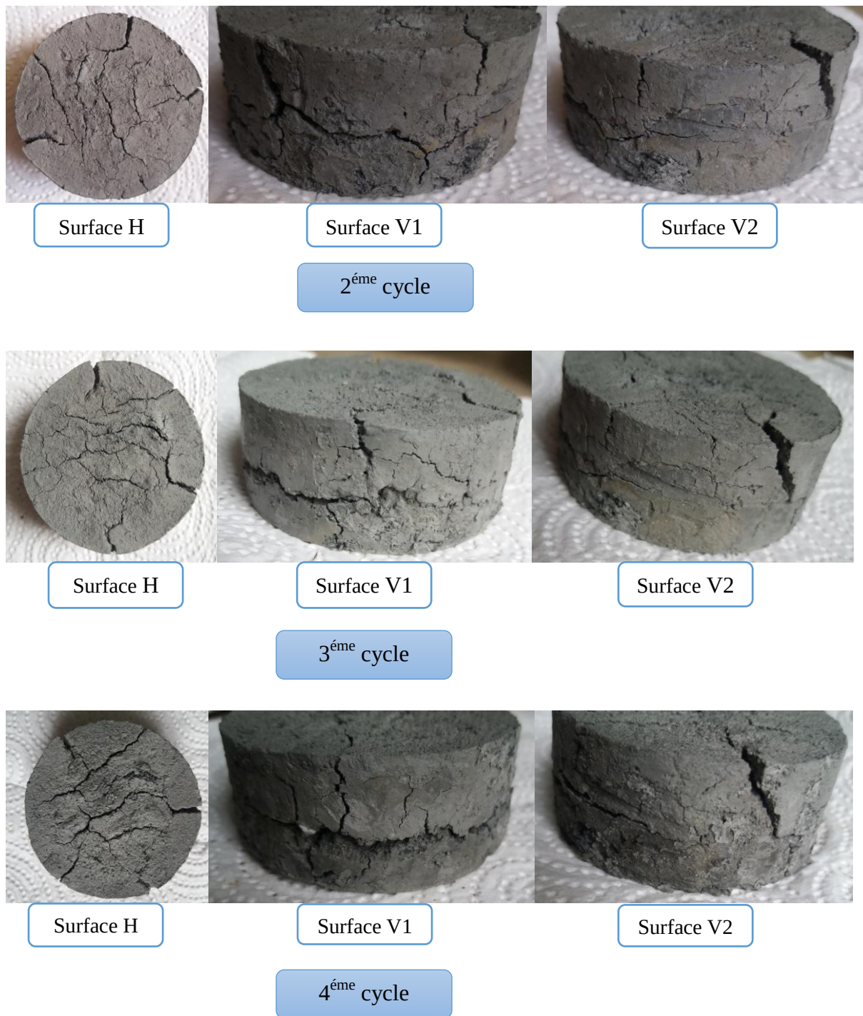
Figure V.9 : Images de l'échantillon de marne de Boghni au cours de l'essai de dégradabilité.
