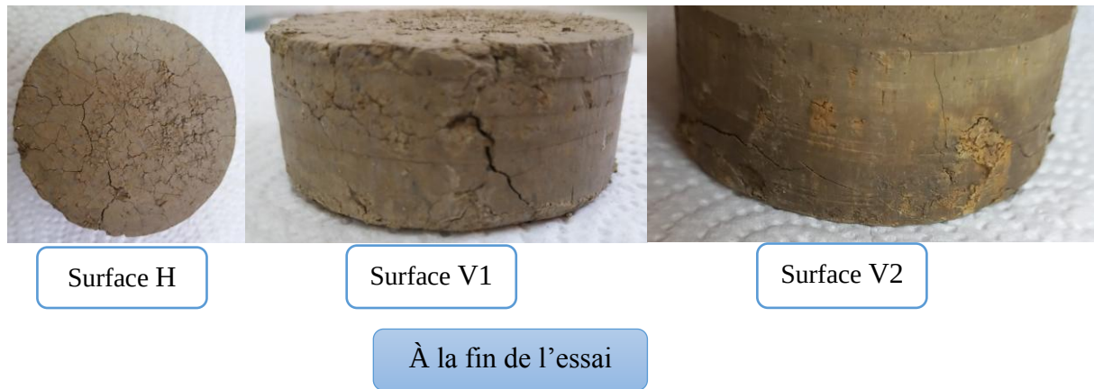
Figure IV.7: Images de l'échantillon de la marne d'Ouad Fali au cours de l'essai aux canicules.
