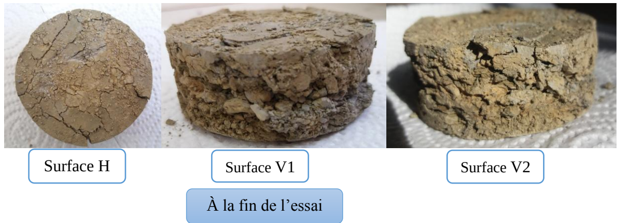
Figure V.3 : Images de l'échantillon de la marne de Mekla au cours de l'essai aux canicules.
