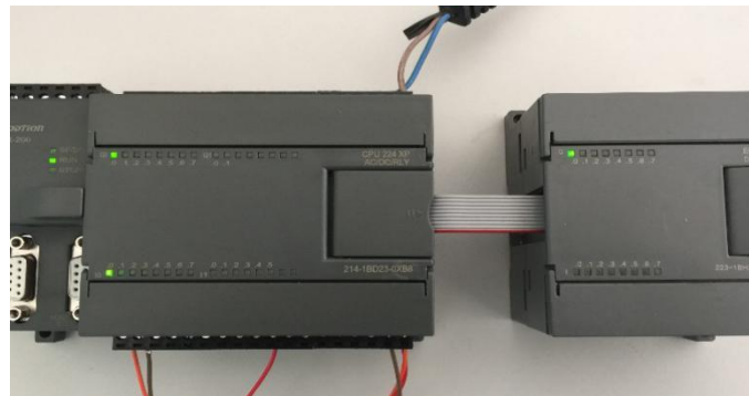
Figure IV.9: Module d'extension relié à la CPU S7-200
