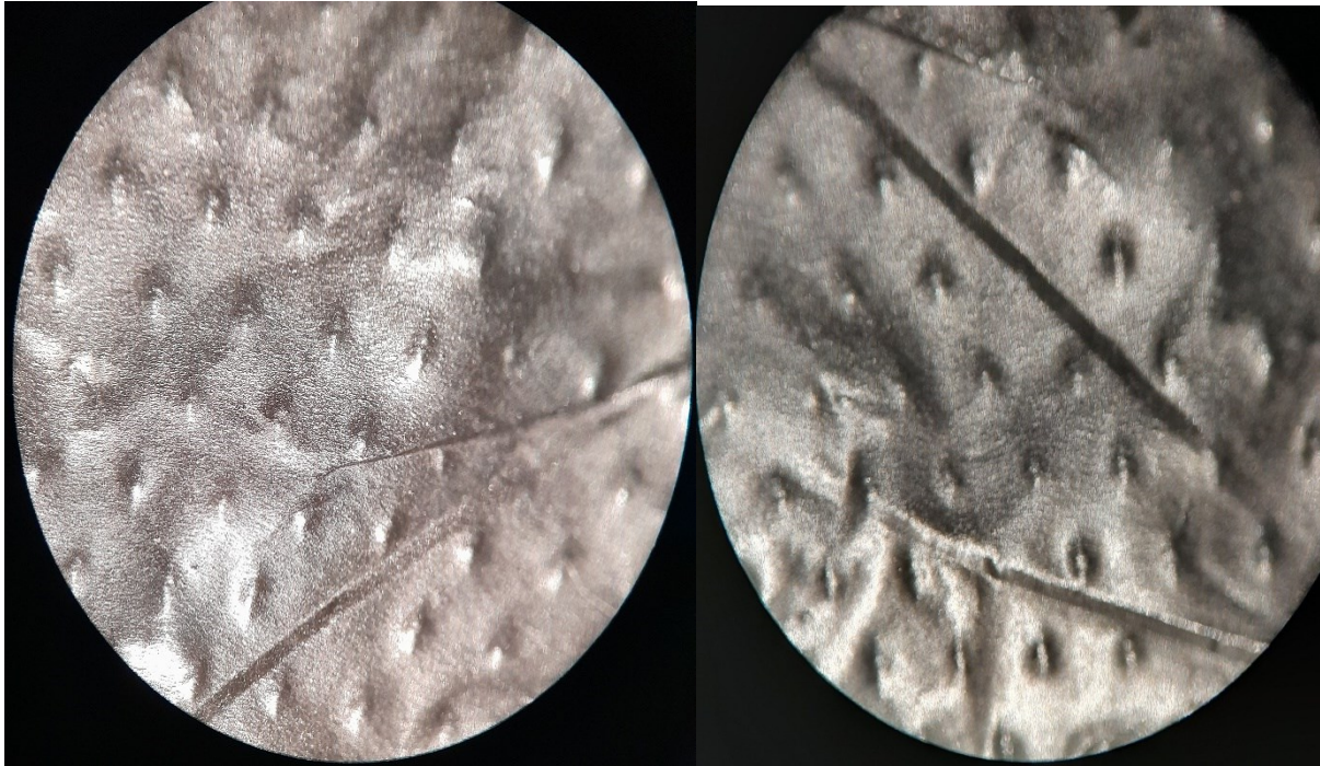
Figure 20 : Observation à la loupe binoculaire (G400) des changements physiques de la surface du sachet noir en PE après biodégradation par la co-culture des deux champignons (original2025).
