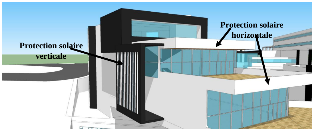
Figure 167: Vue sur des débord de toit sur la façade Sud.
