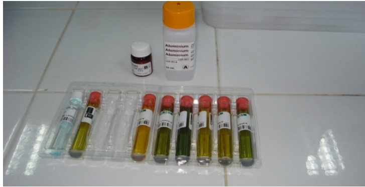
Figure 18 : Apparition de l'aluminium dans le milieu acide avec le Chromazurol S (couleur verte)
