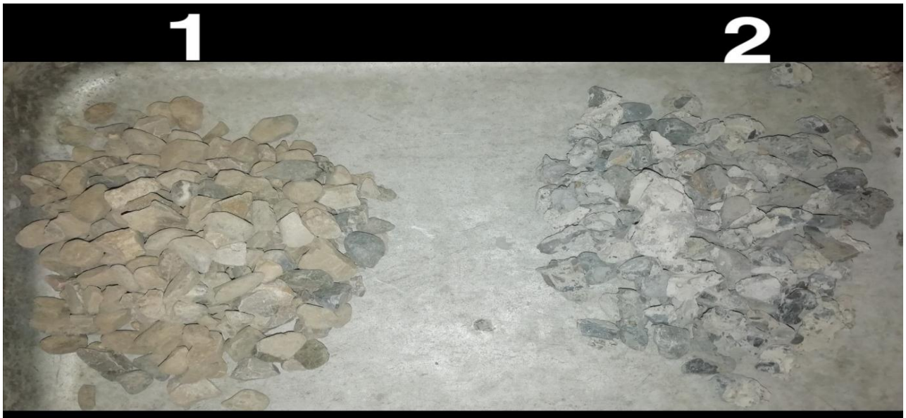
Figure 3: granulats naturel (1) et granulats de béton de démolition (2).
