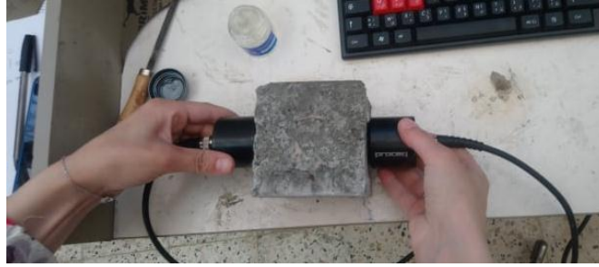
Figure 16: mesure de la vitesse de propagation des ondes
