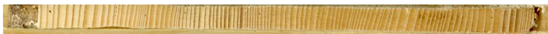
Figure 3.1. Surface poncée d'une carotte après montage sur un support en bois rainuré (échantillon TIG41B).
