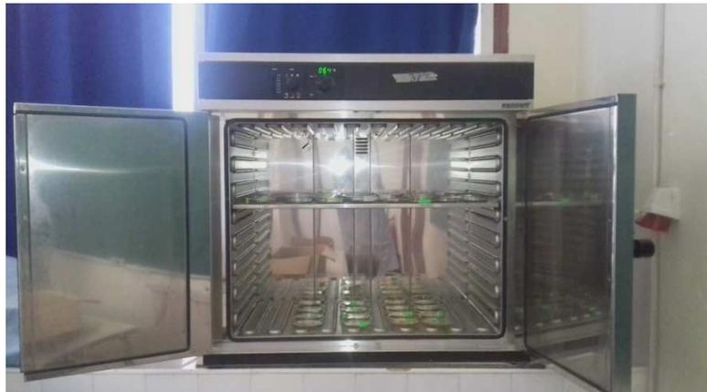
**Figure 11** : Etuve réglée  $103\pm 2^\circ\text{C}$ , afin de déterminer l'humidité de l'huile (Laboratoire microbiologie 2019)
