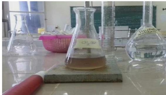
**Figure13** : Détermination de l'indice de peroxyde
