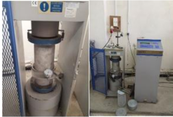
FIGURE II.16: Epreuve soumise à l'essai de compression.
