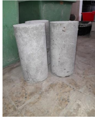
FIGURE II.15 : Les éprouvettes en béton armée.
