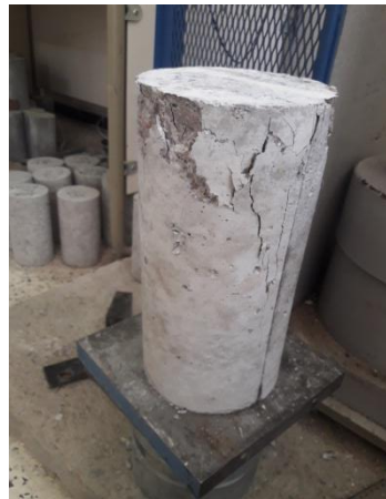
FIGURE II.17 : Epreuve après l'écrasement.
