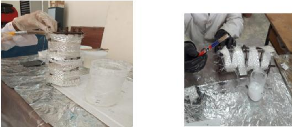
FIGURE II.7 : La mise en place des bandes de tissu de verre.
