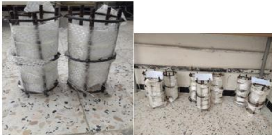
FIGURE II.8 : Séchage des armatures renforcées.
