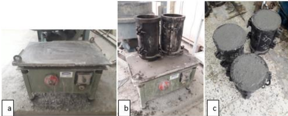
FIGURE II.13: Finalisation de la confection des éprouvettes.
