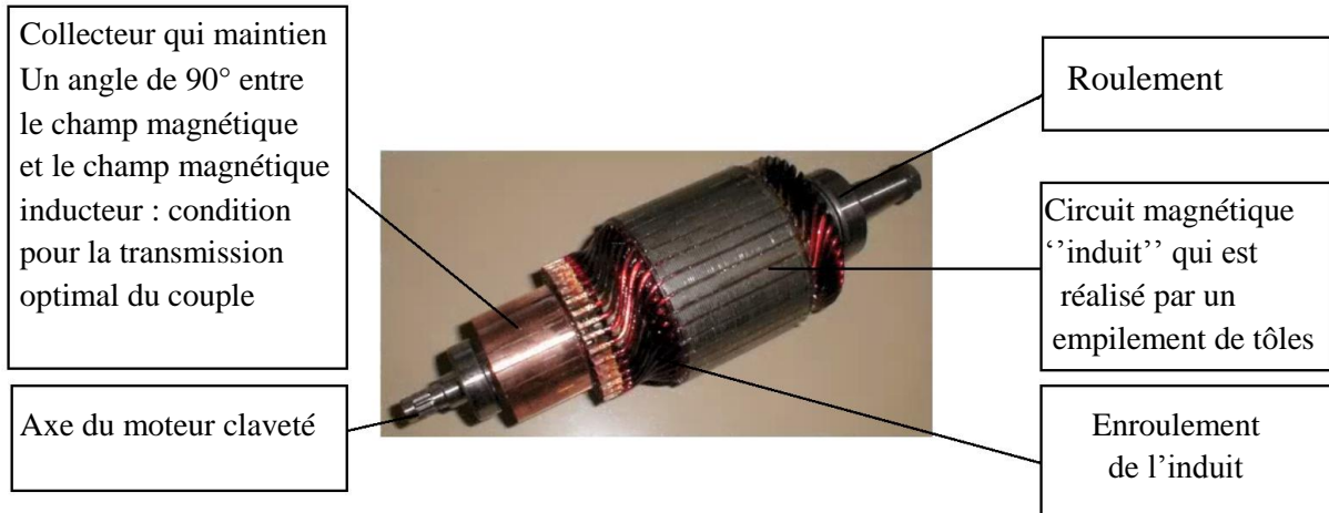
Figure II.4 : Rotor du moteur.
