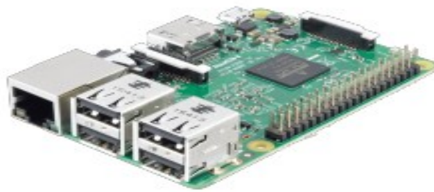
Fig.III.10 Raspberry PI sert d'unité de gestion centrale pour les lecteurs d'une ferme.
