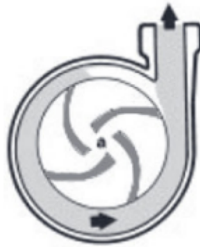
Figure II.19 - Coupe d'une pompe centrifuge.
