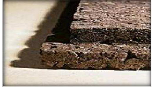
**Figure169 :** Liège expansé pur
