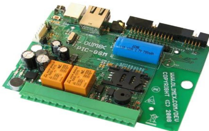
La figure 10: exemple d'un module GSM (composition interne).
