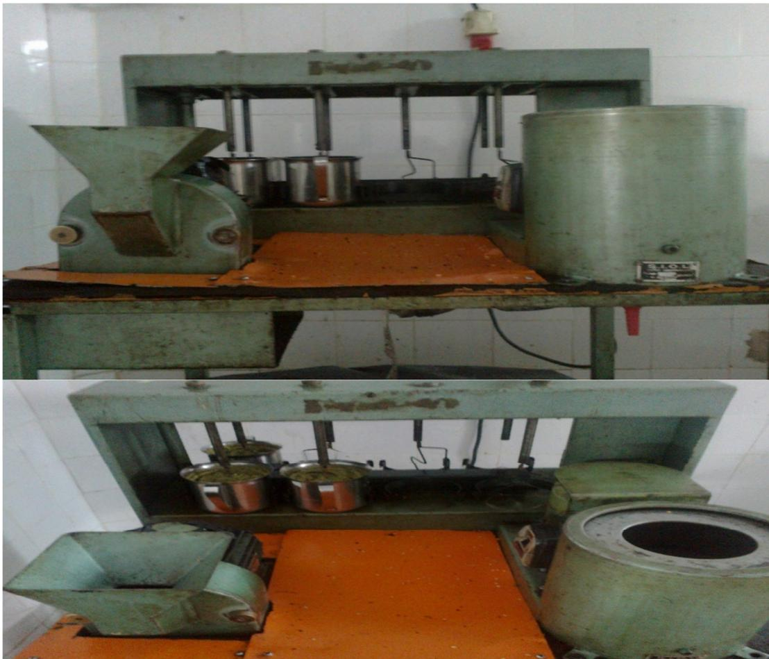
**Figure 15:**photos d'un oléodoseur(photo originale)
