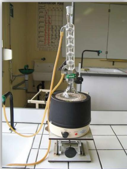
**Figure 16** : réfrigérant à reflux pour l'indice de saponification (photo originale)
