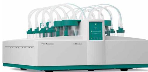
**Figure 17 :** L'instrument de Rancimat 743 utilisé pour déterminer la stabilité à l'oxydation.
