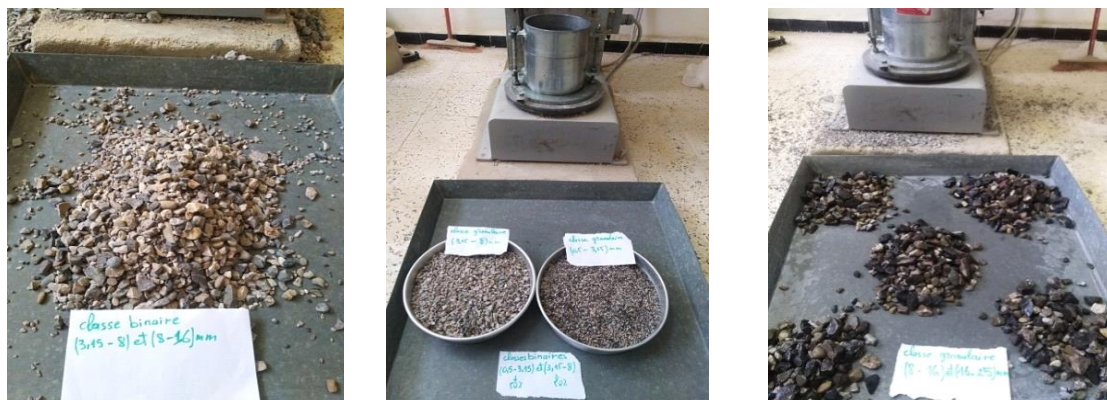
Figure (IV.33). Différentes étapes de l'essai Proctor modifié pour quelques classes binaires.
