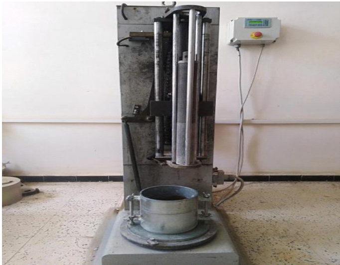
Figure (IV.27). Appareillage de l'essai Proctor modifié selon la norme ASTM D 1557
