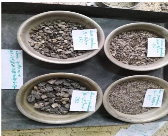
Figure (IV.39). Différentes étapes de l'essai Proctor modifié pour la classe quaternaire.
