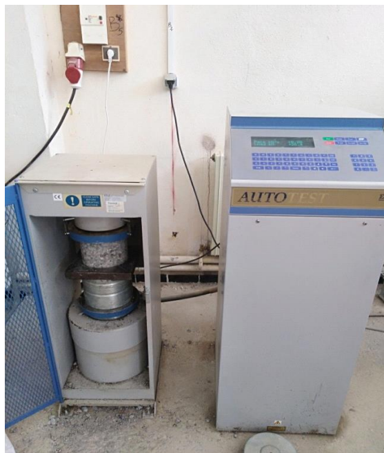
Figure (IV.48). Essai de compression sur éprouvettes cylindriques.
