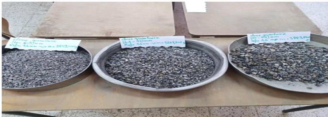
Figure (IV.20). Matériau avant et après essai Los Angeles.
