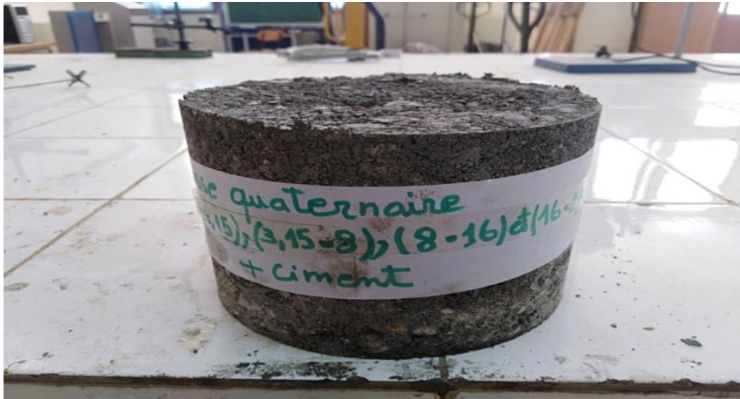
Figure (IV.47). Epreuve du béton compacté pour le mélange quaternaire.
