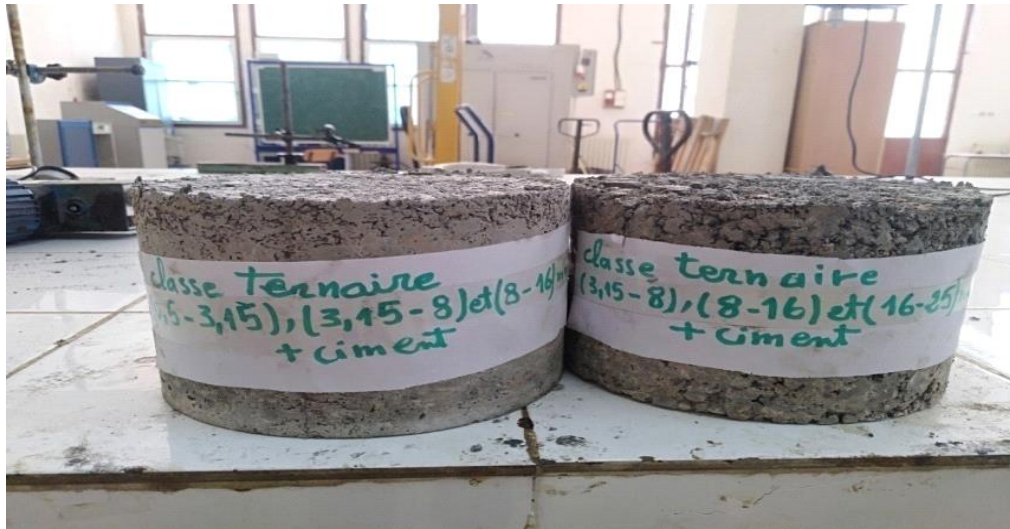
Figure (IV.46). Eprouvettes du béton compacté pour les mélanges ternaires.
