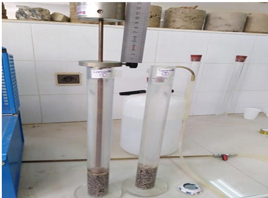
Figure (IV.13). Essai équivalent de sable pour les granulats au laboratoire.
