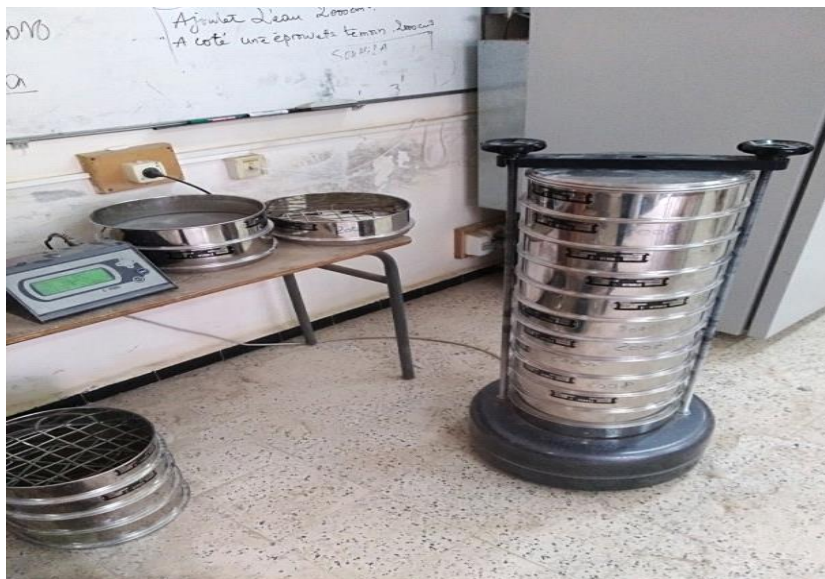
Figure (IV.5). Appareillage de l'essai granulométrique par voie tamisage.
