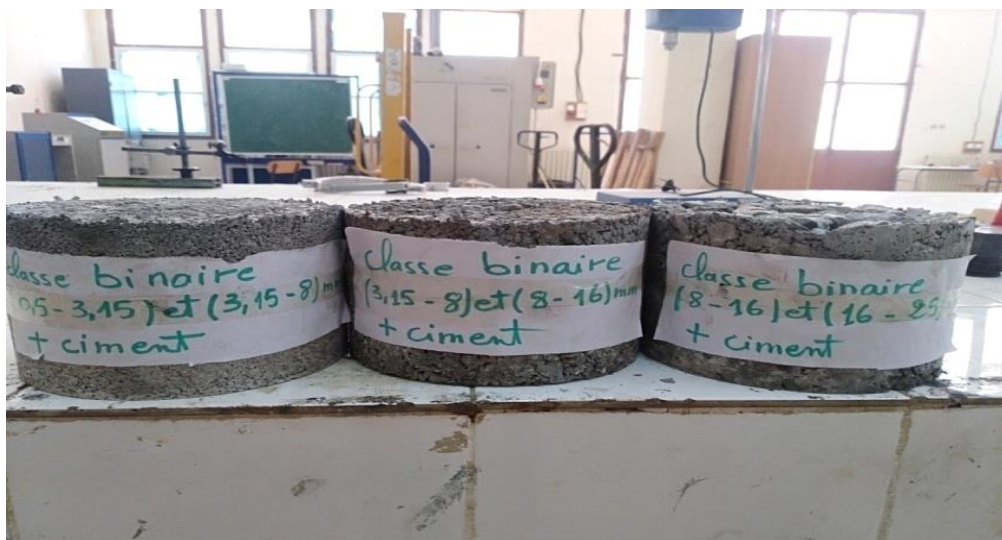
Figure (IV.45). Epreuves du béton compacté pour les mélanges binaires.
