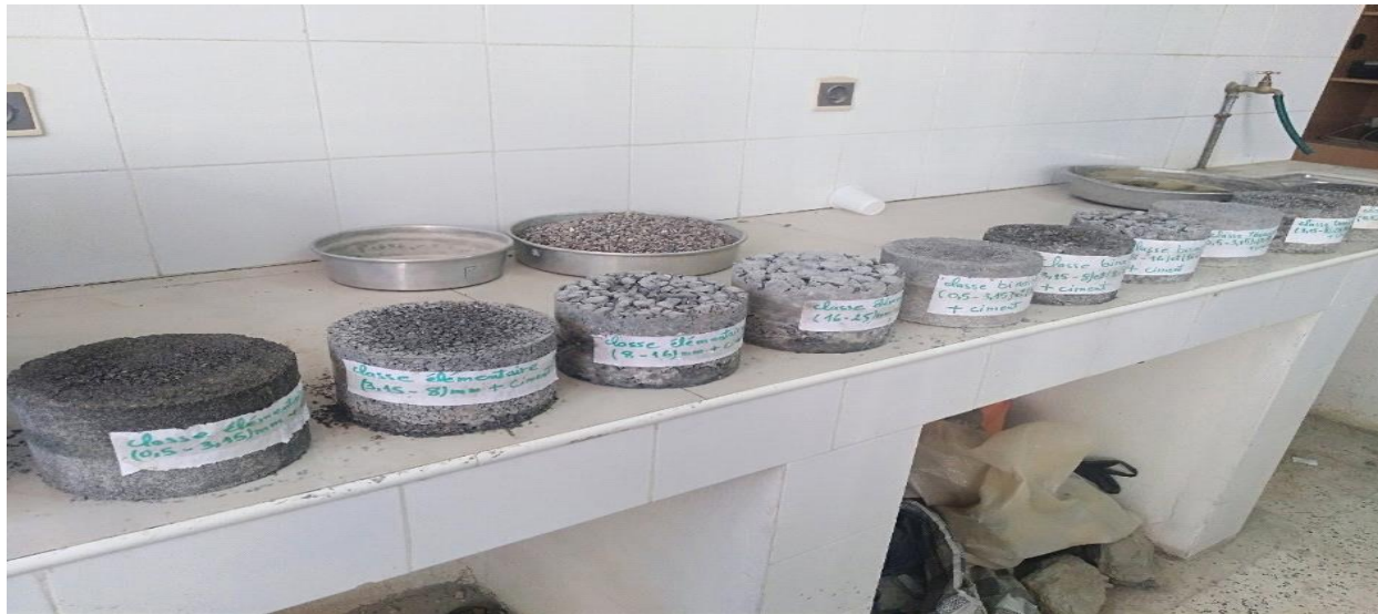
Figure (A). Eprouvettes cylindriques des différents mélanges BCR (élémentaires, binaires, ternaires et quaternaire)
