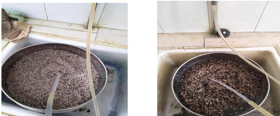
Figure (IV.9). Essai de propreté des granulats (lavage).
