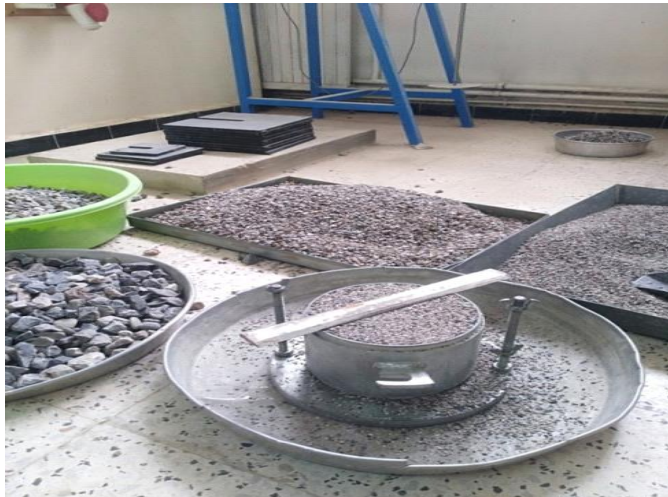
Figure (IV.15). Essai de la masse volumique apparent sur le moule cylindrique (152 x116,5) mm
