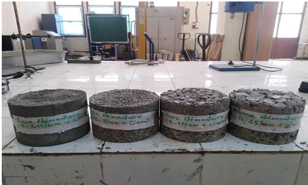
Figure (IV.44). Epreuves du béton compacté pour les mélanges élémentaires.
