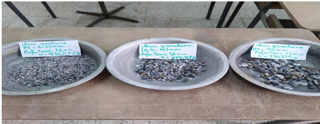
Figure (IV.18). Matériau avant et après essai Micro-Deval
