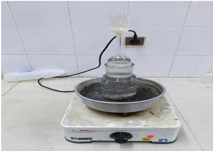
Figure (IV.14). Appareillage de la mesure de la masse volumique absolue (pycnomètre)
