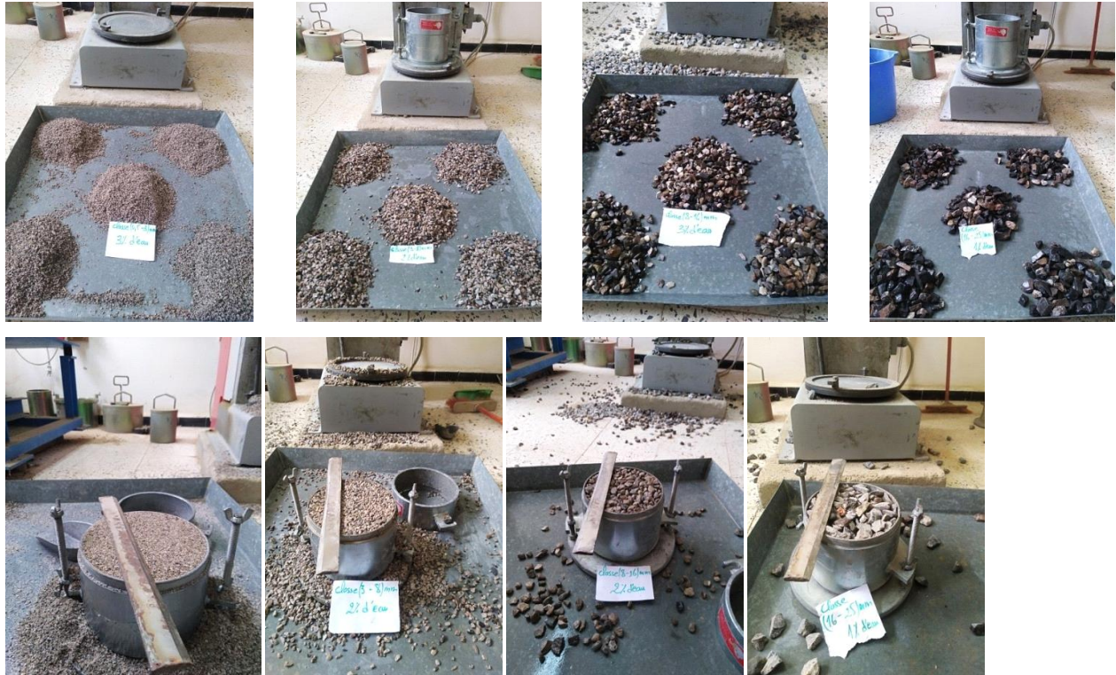
Figure (IV.30). Différentes étapes de l'essai Proctor modifié pour quelques classes élémentaires.
