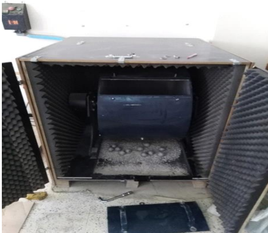
Figure (IV.19). Appareil de l'essai Los Angeles.
