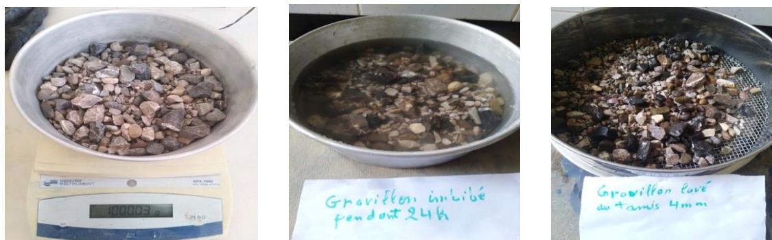
Figure (IV.10). Absorption d'eau d'un gravillon
