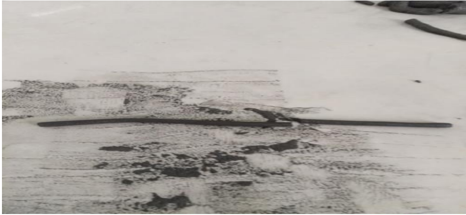
Figure (IV.22). Limite de plasticité de ciment MATINE.
