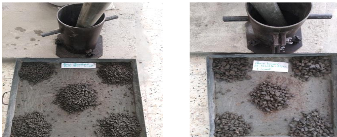
Figure (IV.43). Compactage des mélanges selon le procédé Proctor Modifié (ASTM D 1557)
