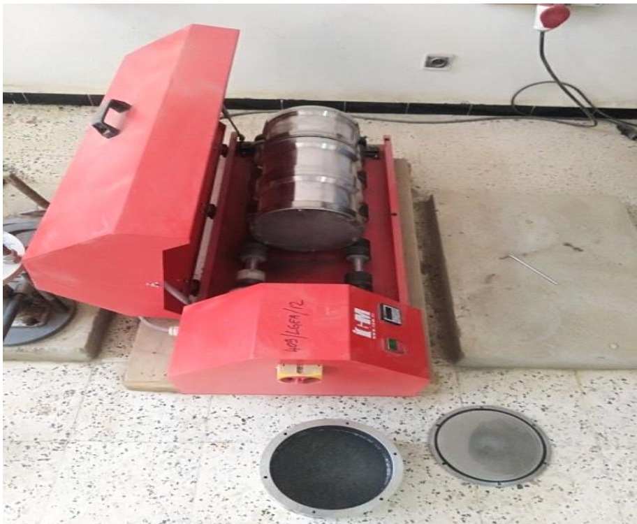
Figure (IV.17). Appareil de l'essai Micro-Deval
