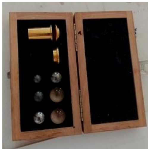
Figure 2.1. Bille utilisée pour la mesure de la viscosité
