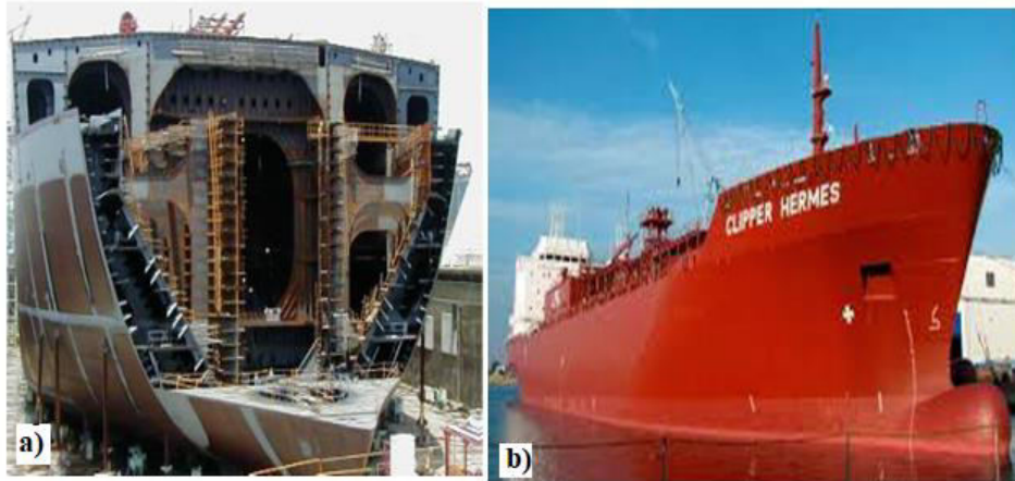
Figure I.14 : Construction des navires en acier : a) Charpente en acier, b) Navire en acier.
