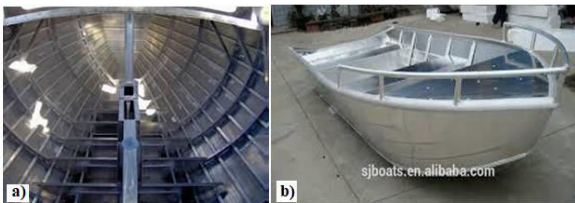
Figure I.15 Construction des navires en aluminium: a) Charpente en aluminium, b) Navire en aluminium.
