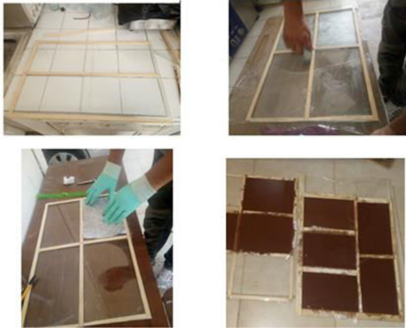
Figure III.8 étapes d'élaboration et d'utilisation du moule
