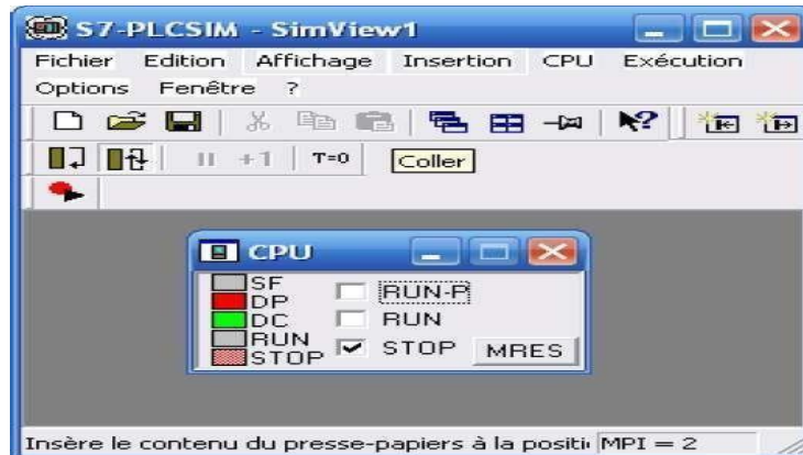
Figure IV.1: fenêtre du S7-PLCSIM.
