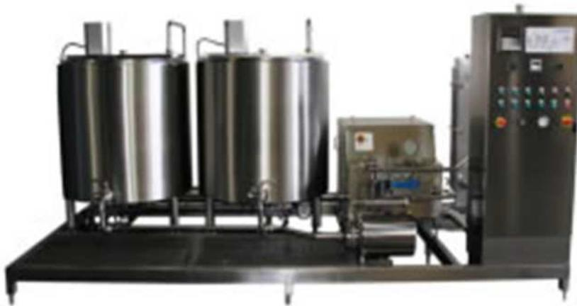
**Figure 04 : homogénéisateur et pasteurisateur (GINI GLACE).**
