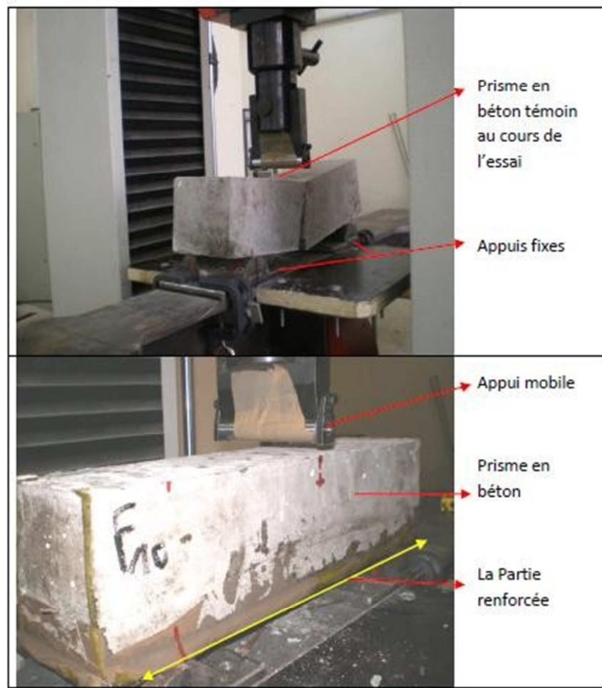
Figure 9 : Essai d'écrasement en flexion trois points.
