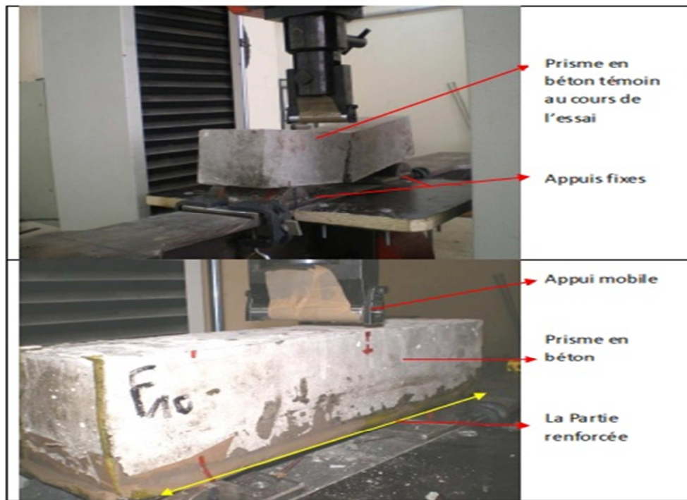
Figure II.13 : Écrasement d'un prisme en béton renforcé par des matériaux composites [39].
