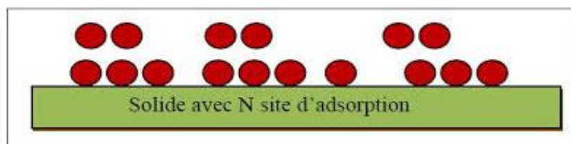
Figure I.4 : Modèle d'adsorption de multicouches [35].
