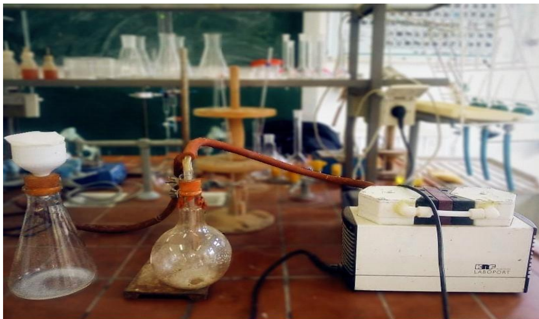
Figure II.3 : Filtration et lavage
