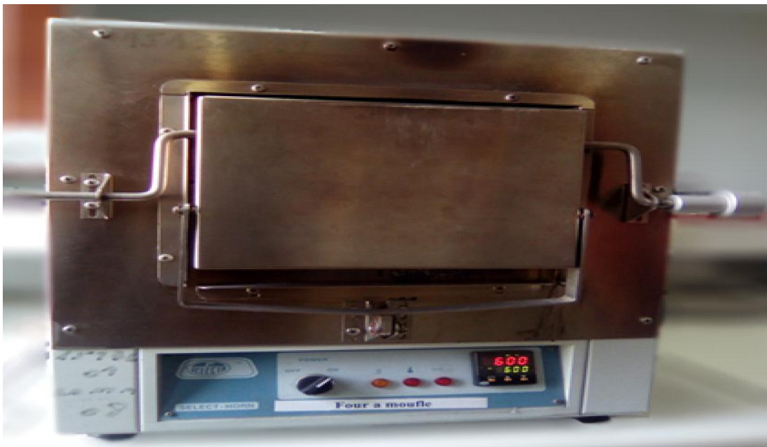
Figure II.6 : Calcination du matériau dans un four à moufle.
