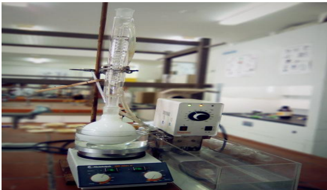
Figure II.2 : Chauffage à reflux
