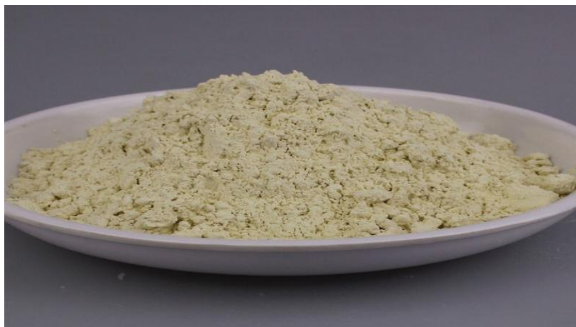
Figure II.7 : Produit de calcination (Spinel).
