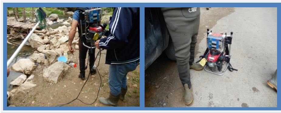
Figure 29: Matériel de la pêche électrique, cuissard imperméable et isolant, non conducteur, un appareil électrique, une sonde et une époussette.
