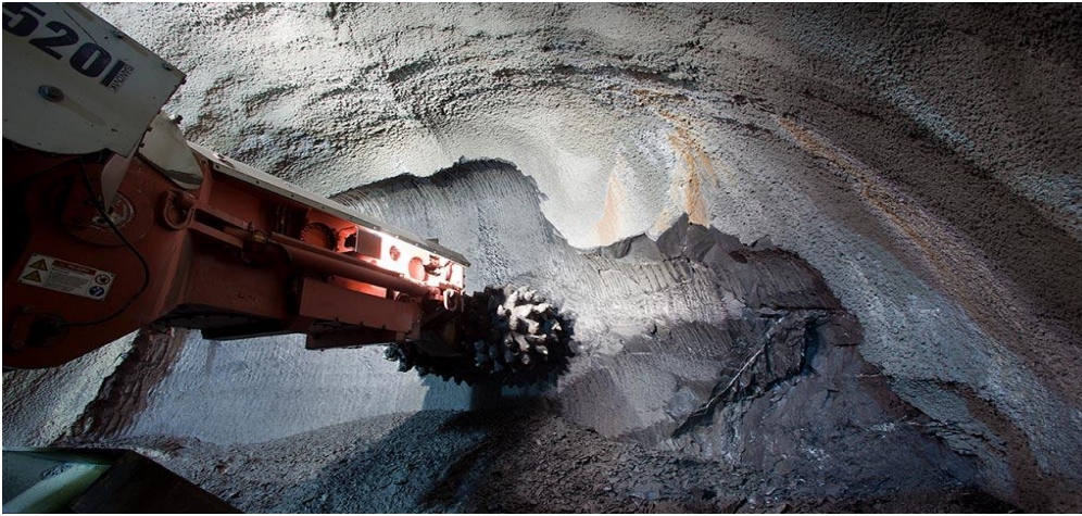
Figure 1.8. Exemple d'une machine à attaque ponctuelle.
