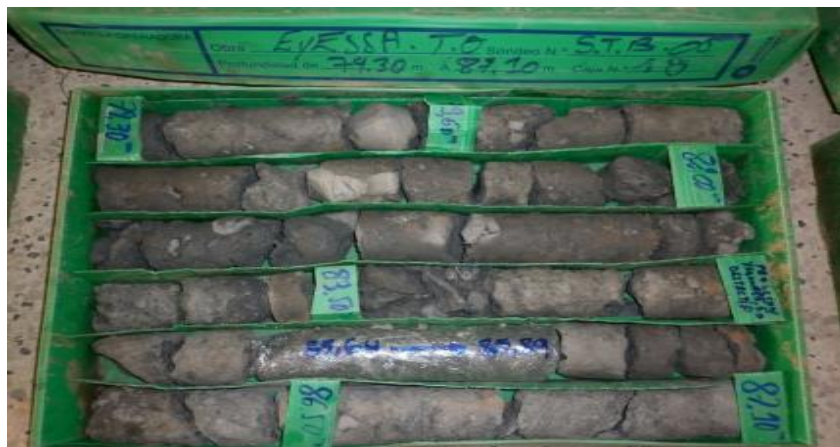
Figure 3.5. Caisse sondage STB-05 de (79.30-87.10m).
