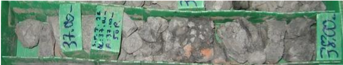
Figure B.2 : calcul de RQD carotte de sondage ST-B01 prof 37.00 - 38.00.
