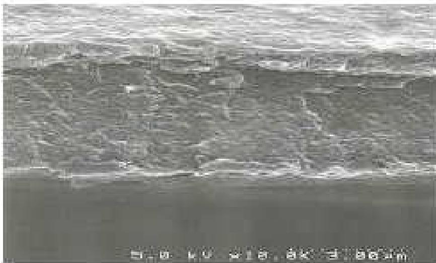
**Figure IV.1 : Structure en coupe de la MPP (image MEB).**
