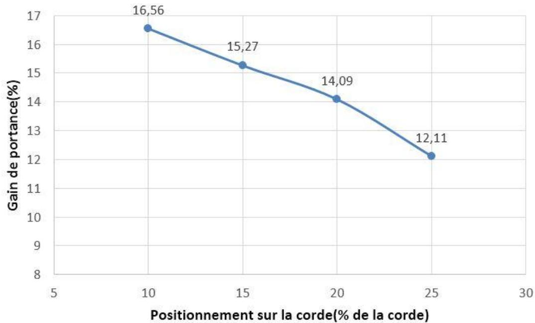
Fig.4.28 Gain de portance en fonction du positionnement sur la corde.
