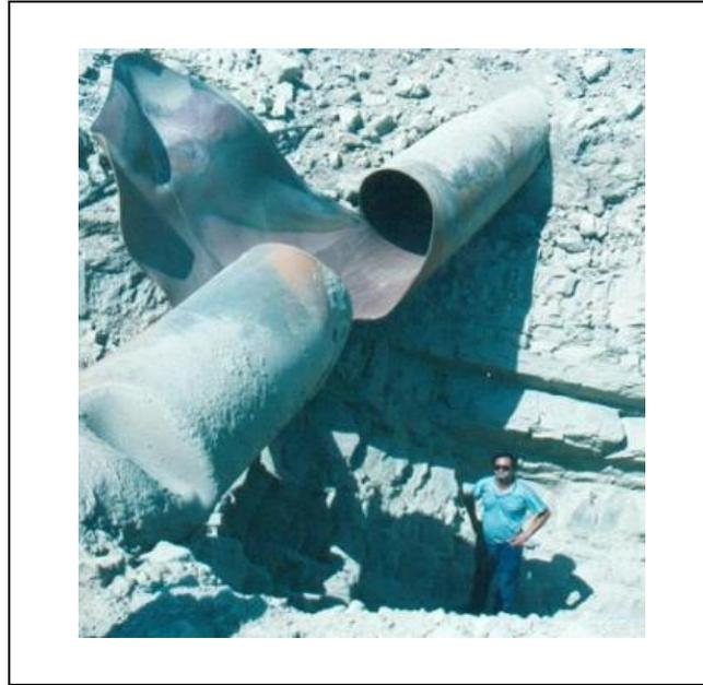
*Figure.II.1b Eclatements avec rupture franche de la canalisation [8]*
