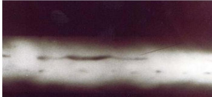
*Figure.I.8 Inclusions de laitier décelées par radiographie [2]*
