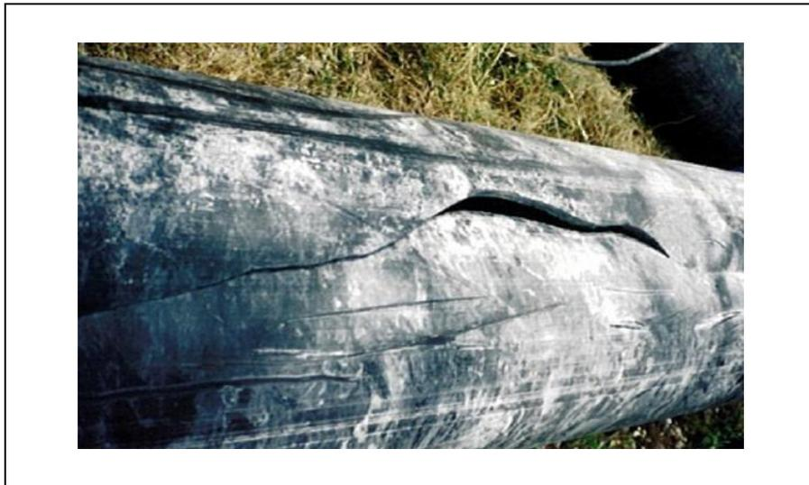
*Figure.II.21 Rupture longitudinale d'un tube en PEHD [18]*
