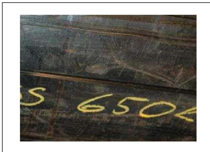
*Figure.II.20 Eraflure sur paroi externe d'un tube PEHD [9]*
