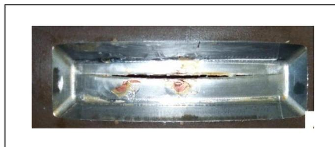
Figure.II.7 défaut usiné avec entaille en V sur le métal de base [10]
