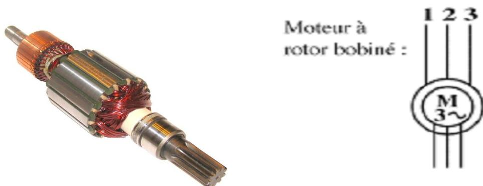
Figure I.2. Présentation du rotor bobiné à bague.
